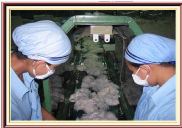
Figura 2.24: Control con luz ultravioleta
