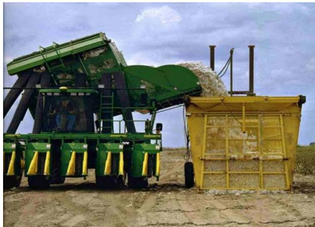
Figura 2.4: Cosechadora de husillos descargando en un molde de módulos
