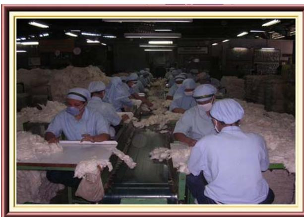
Figura 2.23: Algodón limpio sobre la cinta transportadora
