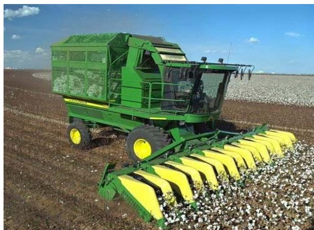
Figura 2.2: Típica cosechadora de cápsulas (no selectiva)
